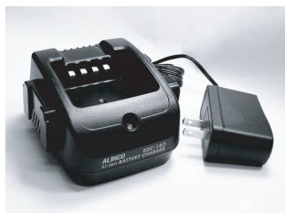
付属の充電スタンド EDC-183R と AC アダプター EDC-283 は電池単体でも充電できます。
