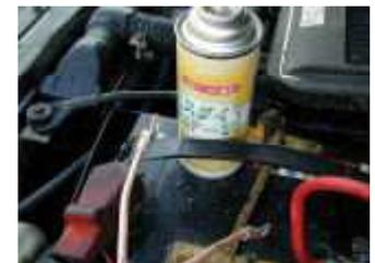
電源コードからの電波の回り込みを防止します、バッテリーから接続する電源コード大電力をつかいますと、電波のまわりこみにて、エンジンノイズをカットします、ノイズ原因を調べるのには大変便利な電磁波のスプレー塗料缶です、車のマイコンの誤動作に役立ちます
