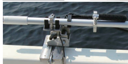
水中カメラを船べり取り付け治具に装着
