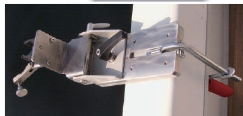
船べりに取り付け治具を固定した状態
