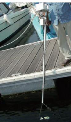
伸縮ポールを最長に伸ばし カメラ部分を水没させた状態
